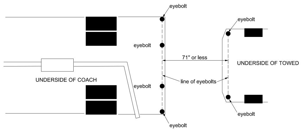
NOTE: FOR DISTANCES 71" OR LESS THE STANDARD PROTECT-A-TOW SHOULD BE ORDERED FOR DISTANCES OF 72" OR MORE THE EXTENDED UNIT SHOULD BE ORDERED.
